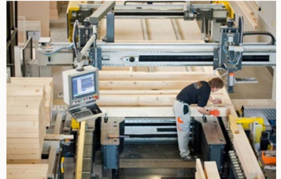
Holz-Fertighäuser werden mit computergestützten Maschinen industriell vorgefertigt. Foto: BDF/FingerHaus/Rolf Vennenbernd
